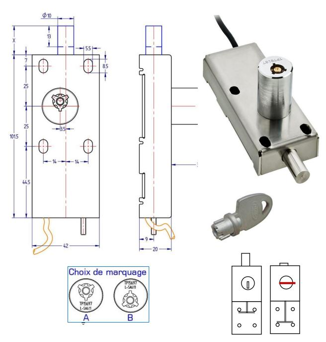
Verrou et pêne en inox AISI 304 - Cylindre laiton chromé avec goupilles et ressorts en inox AISI 303. Clé étoile type BOROBIL : 97.000 combinaisons.
